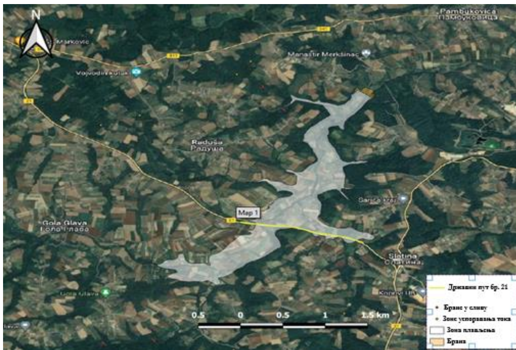
Слика 3 - Локација бране и акумулација у односу на оближња насеља и државни пут број 21 (који ће бити измештен/подигнут)
